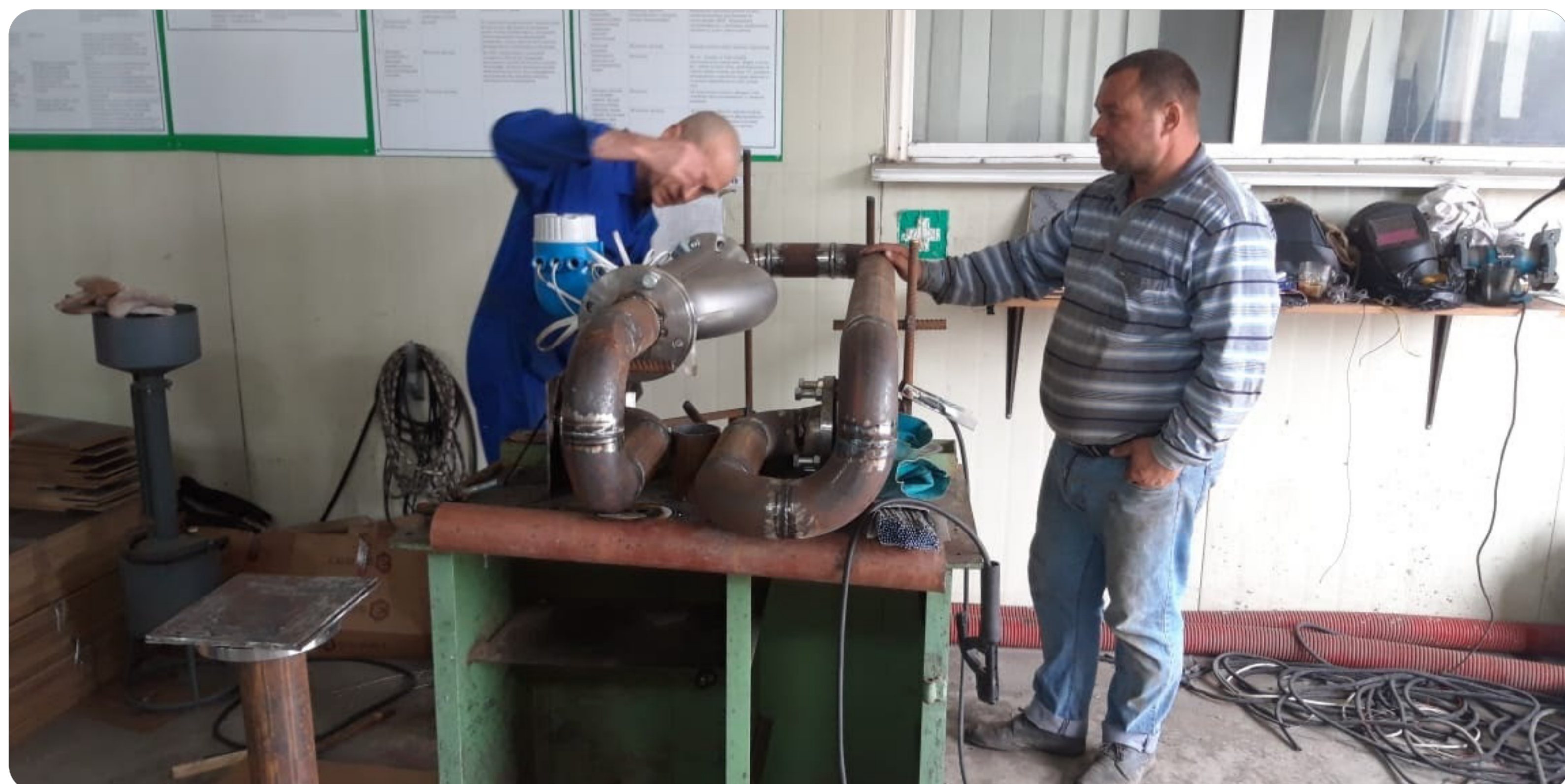
ПРОЦЕСС СВАРКИ ТРУБ ПО ЛЕКАЛАМ В МАСТЕРСКОЙ
