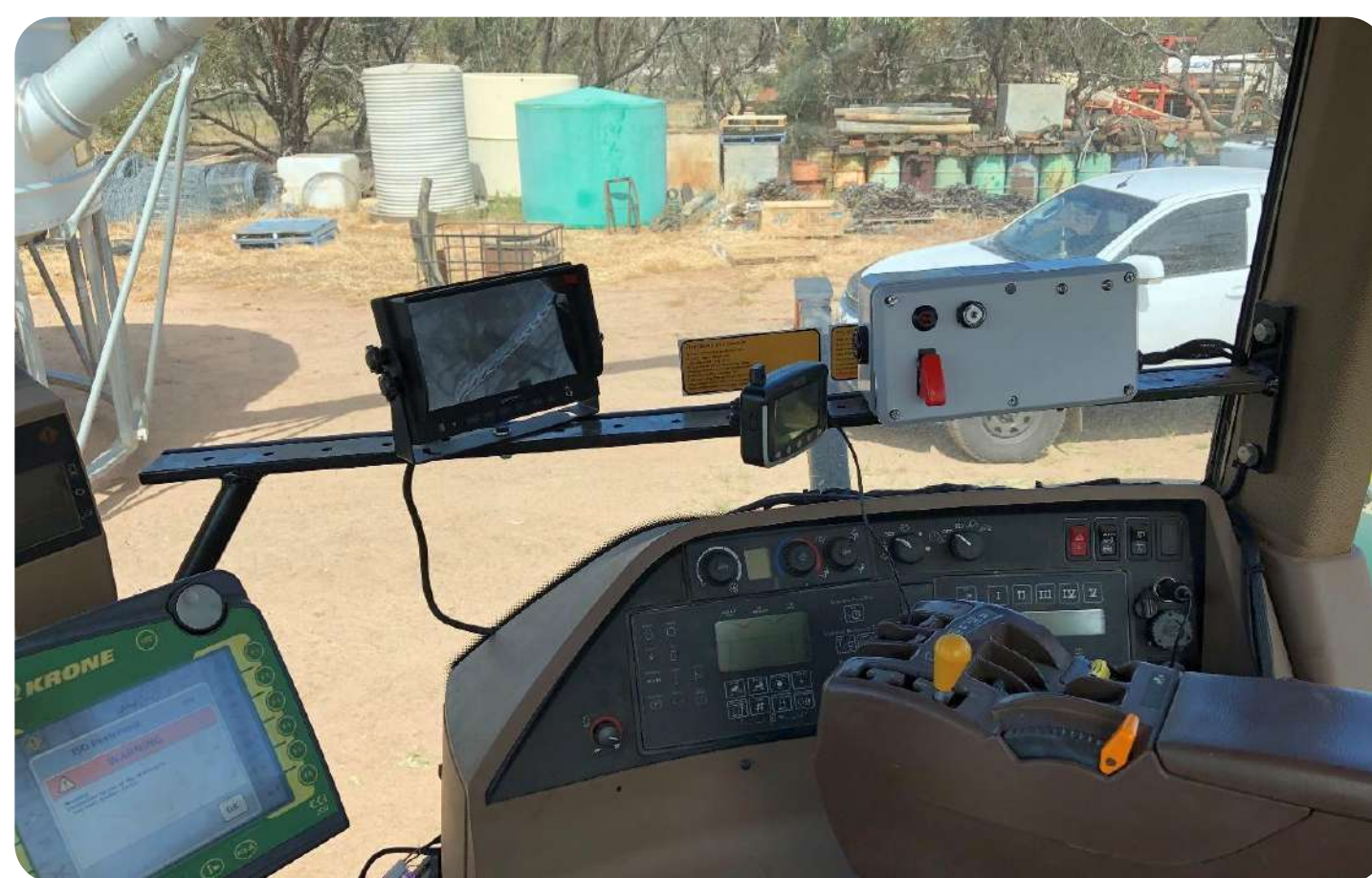
LA BOÎTE BLANCHE AVEC L'APPAREIL DE SUIVI, LE LECTEUR IBUTTON ET LE BOUTON POUR ENREGISTRER LES BALLES RÉEMBALLÉES
